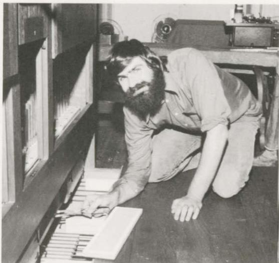
ポジティブのトラッカーのパネを点検する
