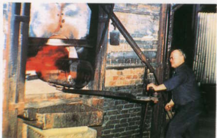
10 切り目の入った筒を別の炉に入れ、熱を加えて平にする。
