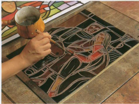
10 型紙⑩をその下に敷いた透明な厚板ガラスの上にコントロールの終わったガラス片を並べ、グラグラ煮立てた液体ろうで接着固定する。
