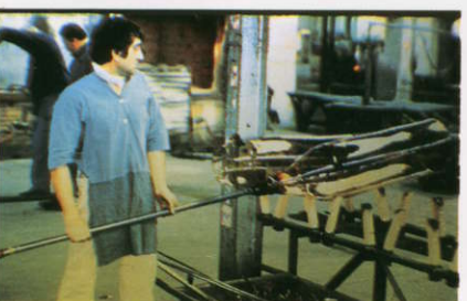
8 十分に長くなったシリンダー状のガラスを台の上におき、筒の両端をカットする。
