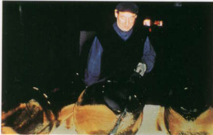
9 筒状のガラスの一部に熱を加えて切り目を入れる。
