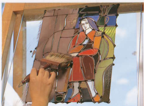
12 全体の調和がとれたガラス片の上によく練りあげ、適当な濃度になった顔料を幅広のハケでまんべんなく、すばやくかける。
