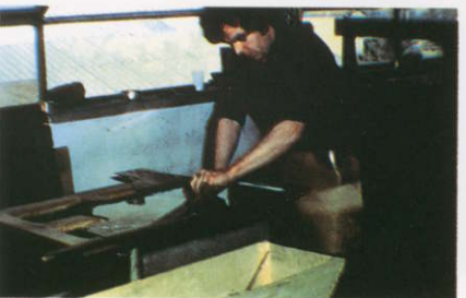
12 ガラスの四方を切断し形を整えて完成品になる。
