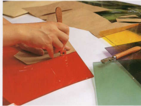
7 型紙のガラス色番号に従って棚からガラスをとり出し、その上に型紙を置いて輪郭に沿って切る。
