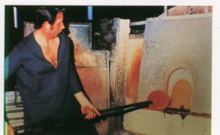
2 りつぽの中から鉄のパイプでガラスだねをとり出す。
