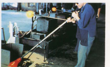
3 パイプを吹きながらガラスの表面に泡や切子状の傷をつけ、ガラスが乱反射する要素をつくる。
